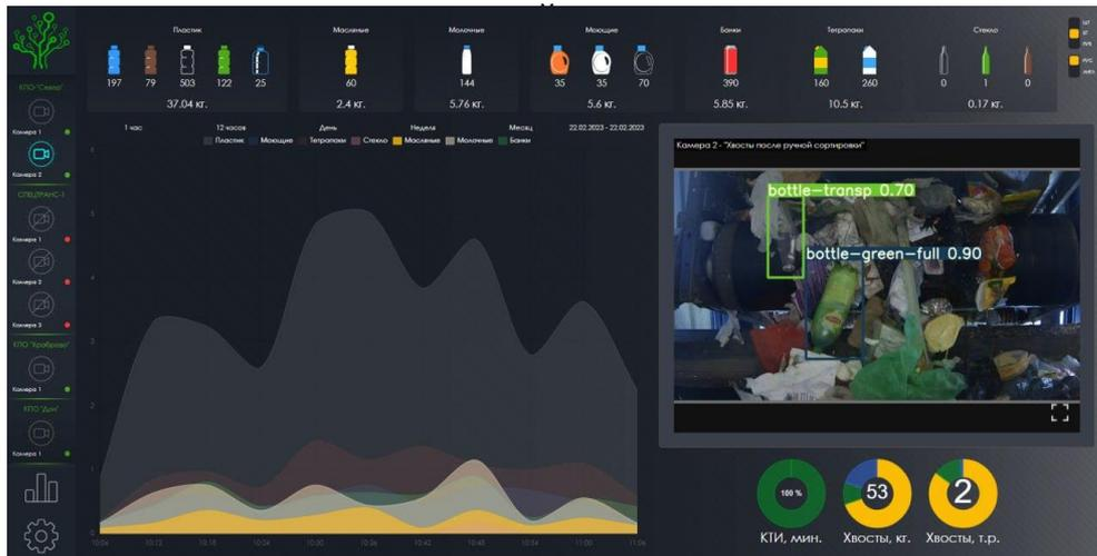
Интерфейс системы контроля сортировки отходов
