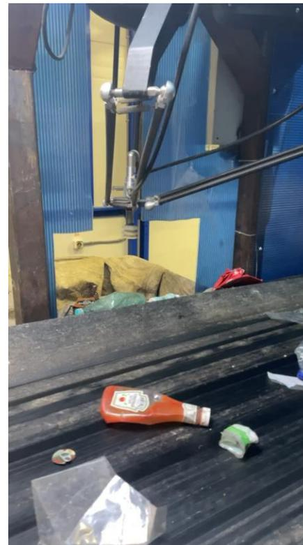
Роботизированная сортировка отходов
